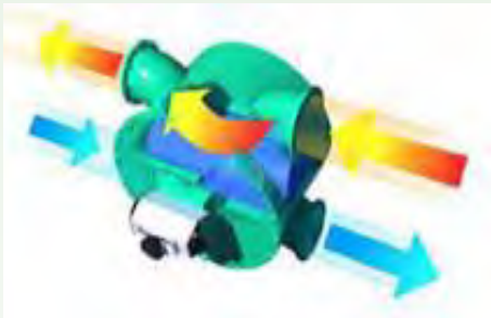
四通水流换向阀动作 1 水流处于正常状态
