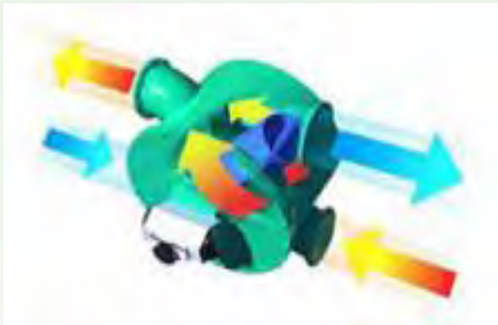
四通水流换向阀动作 2 水流处于逆流状态
